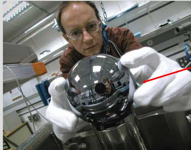
Kugle fremstillet af ren ^{28}\text{Si} krystal
